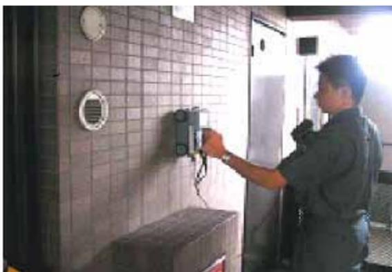
一級建築士事務所であるソーシャル・ジャジメント・システム(以下、SJSという)では、マンション住民の要望に答えて、検査会社と提携し、非破壊検査法による鉄筋コンクリートなどの強度診断を行っている。この検査では左図のような表現で、鉄筋の位置やコンクリートのかぶりを明快に表し、構造設計と施工の是非を診断できる。費用は建物の規模や構造により異なるが、約30万円である。
